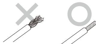
※ケーブルの皮膜を長くむき過ぎないようにご注意ください。ケーブルの導線部同士が接触し、ショートする恐れがあります。
